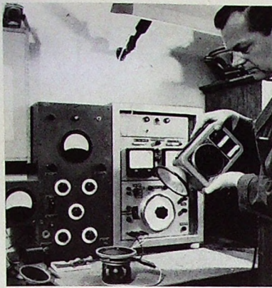
Bild 3. Untersuchung von Taumelbewegungen einer Membran mit dem Stroboskop
